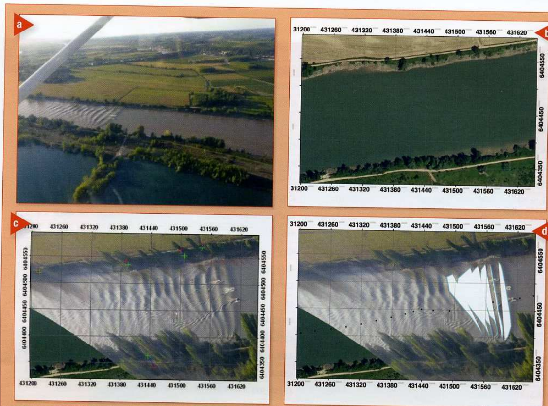
▲ Figure 13 : les différentes étapes pour géoréférencer les photographies aériennes : a : photo aérienne P1050680, Pk 44.6, 17h19 TU avec le mascaret qui se propage de la gauche vers la droite ; b : carte IGN 04731-6405 en Lambert 93 ; c : photos superposées sur la carte IGN avec points de géoréférencement ; d : photo redressée et géoréférencée avec la trajectoire du bateau (points) et les traits de mesures des six premières vagues du mascaret qui se propagent de gauche vers la droite.
